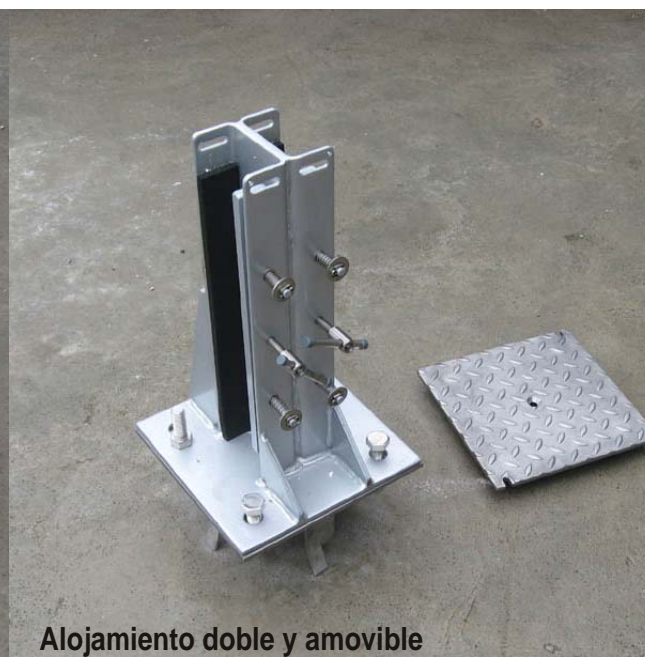
2. Doppelaufnahme an Ankerplatte festschrauben Zwischen Ankerplatte und Doppelaufnahme Dichtung 300 x 300 x 3 mm setzen
