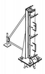
Ab bestimmten Längen und Höhen wird eine Triangelstütze an der Doppelaufnahme befestigt.
